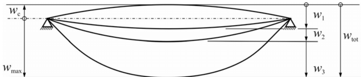
Рисунок 8.1 - Определения вертикальных прогибов
